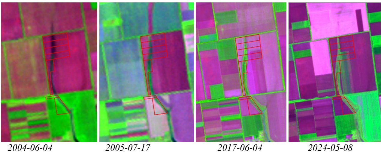
Рис. 7. Супутникові знімки з нанесеними межами земельних ділянок, які накладаються на залужену заплаву терасу та перезволожені ділянки вздовж русла струмка на відповідні дати.
