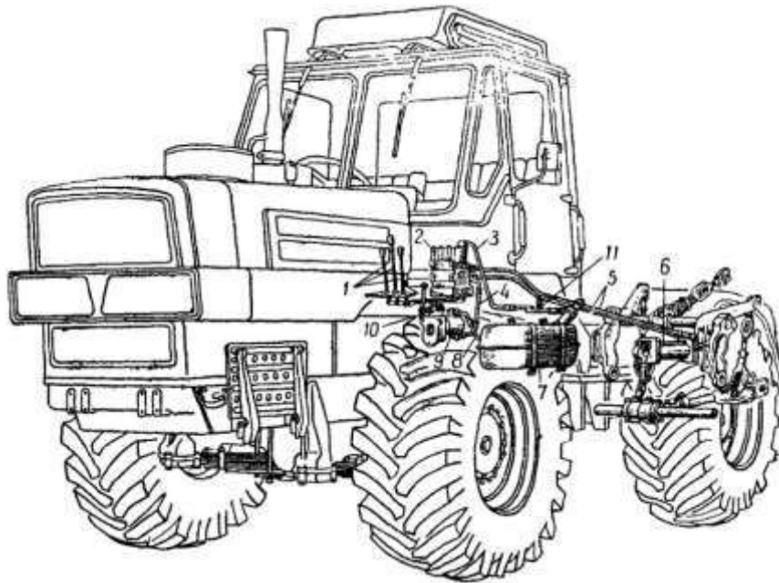
Рисунок. Розташування обладнання і агрегатів гідравлічної системи трактора ХТЗ-17021 та місця проникнення забруднень і витікання оливи в гідравлічній системі: 1 – важелі керування; 2 – золотниковий розподільник; 3,4,5,8 – магістралі гідравлічної оливи; 6 – силовий гідроциліндр; 7 – бак гідравлічної оливи з заливною горловиною і сапуном; 9 – шестеренний насос; 10 – привод і механізм включення; 11 – фільтр і індикатор гідравлічної оливи бака
