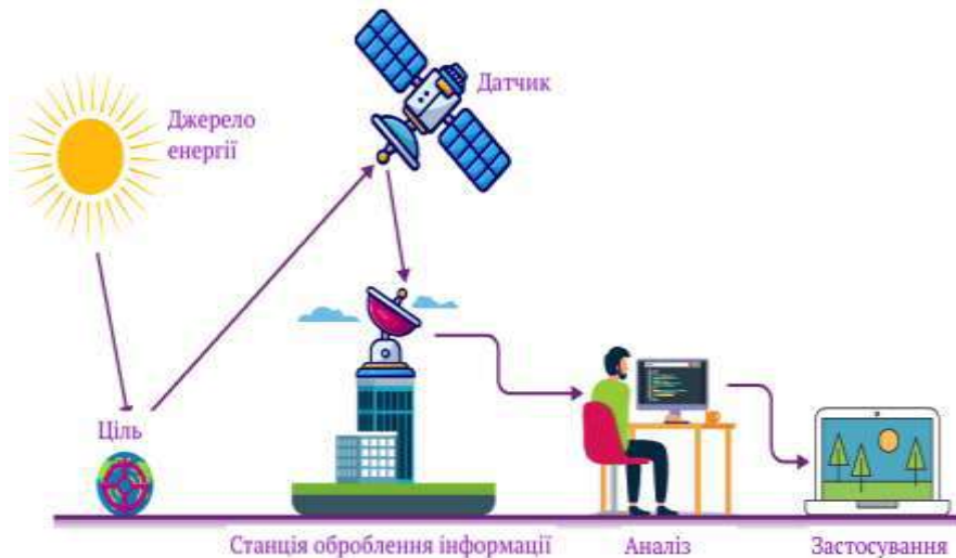
Рис. 2. Умовна схема принципу отримання інформації з космосу за допомогою пасивних датчиків (Джерело: https://byjus.com/physics/remote-sensing/ )
