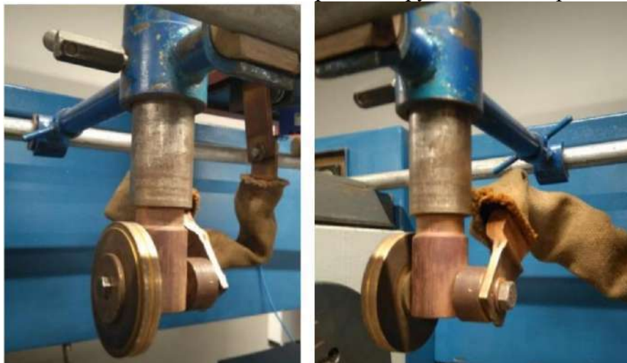
Рис. 3. Загальний вигляд і розташування струмопідвідного пристрою на токарно-гвинторізному верстаті Джерело: сформовано авторами
