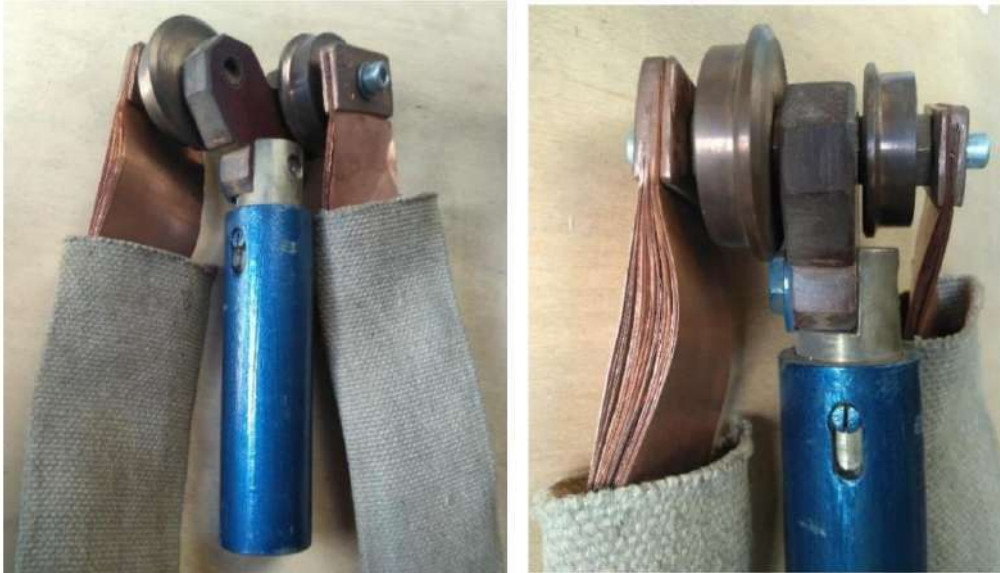
Рис. 4. Державка телескопічна та її кріплення з інструментальним роликом у різцетримачі токарно-гвинторізного верстата
