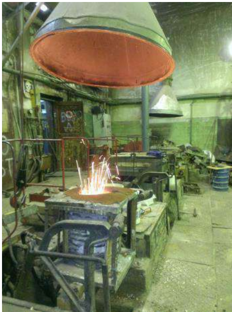
Рис. 1. Процес виплавки сталі у відкритій індукційній печі ИСТ 016
