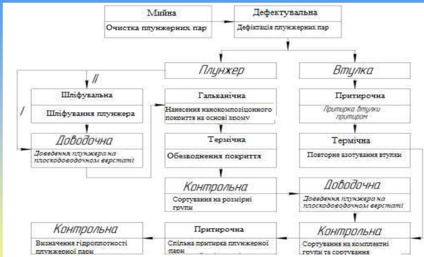
Рис. 3.13. Схема технологічного процесу відновлення плунжерних пар ПНВТ дизеля ЯМЗ-238.
