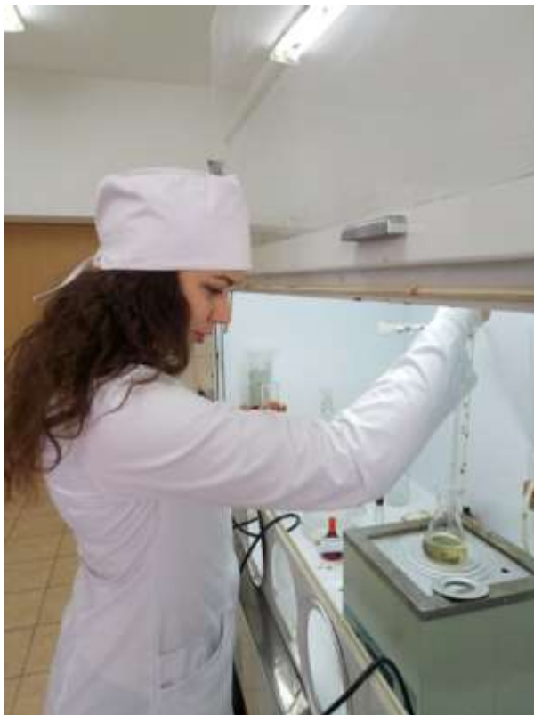
Рис. 4. Підготовка водної витяжки з фаршу для визначення вмісту кухонної солі
