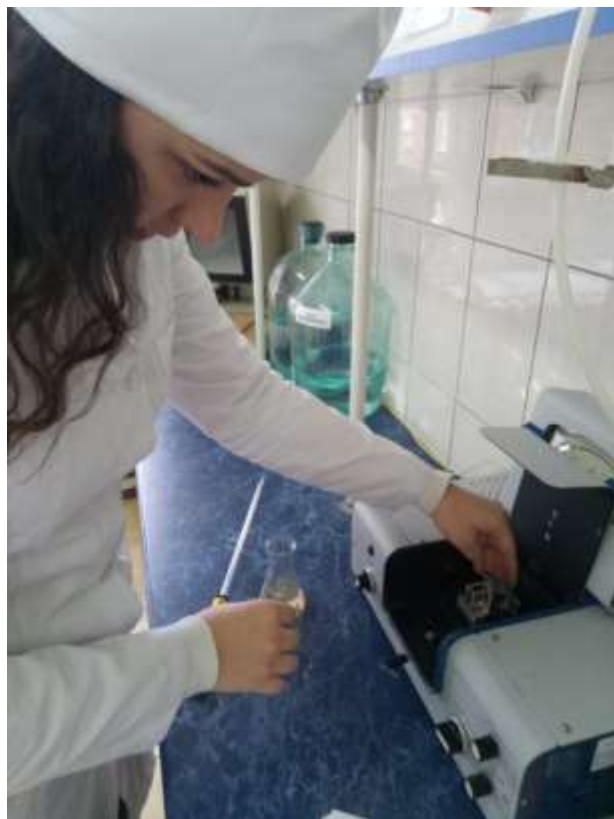
Рис. 6. Визначення нітритів у зразках колориметричним методом (КФК)
